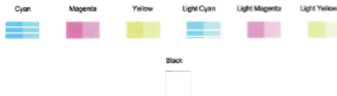
Figura 9-2 Esempi di blocchi di colore con difetti
