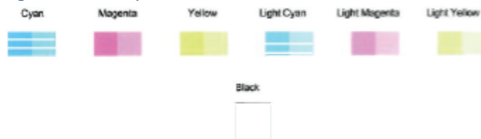
Figura 9-2 Exemple de blocuri de culoare cu defecte
