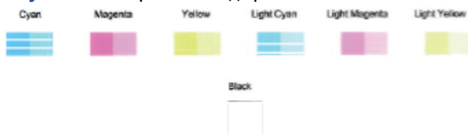
Рисунок 9-2 Колірні блоки з дефектами
