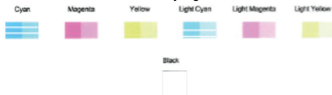
Gambar 9-2 Contoh blok warna yang cacat
