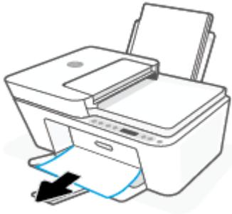
6. Se o carro estiver no centro da impressora, deslize-o para a direita e, em seguida, remova qualquer papel ou objeto que esteja bloqueando o trajeto do carro.
