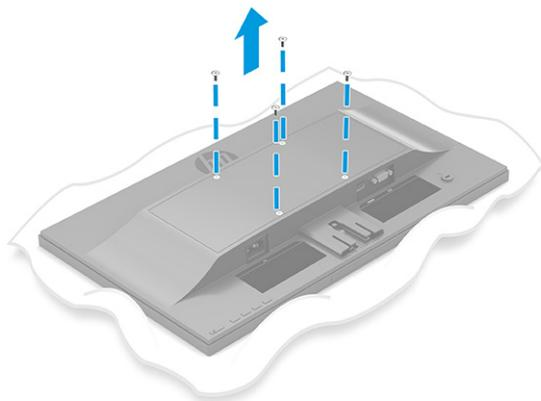
2. Para fijar el monitor a un brazo oscilante u otro dispositivo de montaje, inserte cuatro tornillos de montaje en los orificios del dispositivo de montaje y dentro de los orificios para tornillos del soporte de montaje VESA en la parte trasera del monitor.
