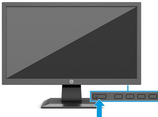
Cuando se enciende el monitor por primera vez, aparece durante 5 segundos un mensaje de estado del monitor. El mensaje muestra qué entrada es la señal activa actual, el estado de la configuración de la fuente del conmutador automático (activado o desactivado; el valor predeterminado es encendido), la resolución de pantalla predeterminada actual y la resolución de pantalla recomendada predeterminada.
