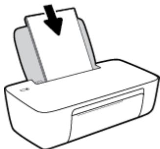
4. 將紙張寬度導板向右推，直到緊貼紙張邊緣後停止。
