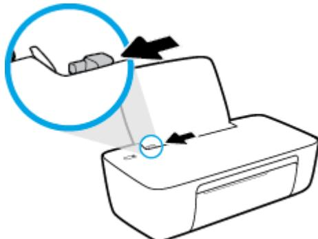
3. 將整疊相紙較短的一側朝下插入進紙匣最右側，列印面朝上。將整疊相紙向下推，直到不能再推入為止。
