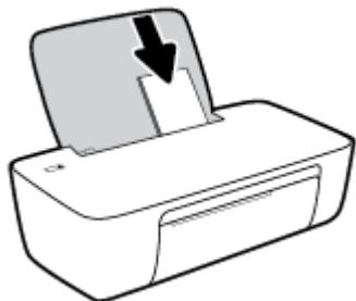
4. 將紙張寬度導板向右推，直到緊貼信封邊緣後停止。
