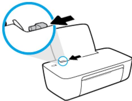
3. 將一個或多個信封插入進紙匣最右側，並將整疊信封向下推，直到不能再推入為止。
