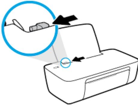
3. Τοποθετήστε έναν ή περισσότερους φακέλους στη δεξιά πλευρά του δίσκου εισόδου και σύρετε τη στοίβα φακέλων προς τα κάτω μέχρι να σταματήσει.
