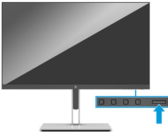
Cuando se enciende el monitor por primera vez, aparece durante 5 segundos un mensaje de estado del monitor. El mensaje muestra qué entrada es la señal activa actual, el estado de la configuración de la fuente del conmutador automático (activado o desactivado; el valor predeterminado es encendido), la resolución de pantalla predeterminada actual y la resolución de pantalla recomendada predeterminada.
