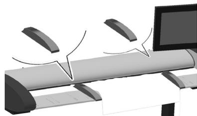
Η συσκευή HP Designjet διαθέτει δύο οδηγούς μαγνητικών μέσων, τους οποίους μπορείτε να τοποθετήσετε και να μετακινήσετε ανάλογα.
