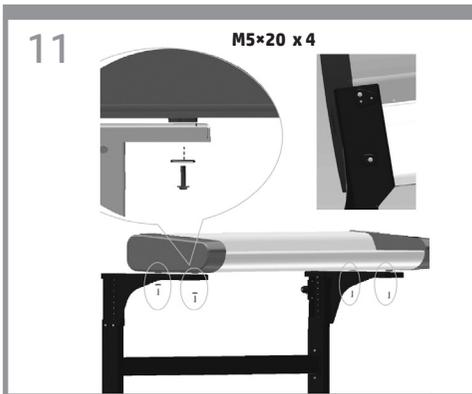
**EL** Στερεώστε με τις τέσσερις ειδικές βίδες. Οι πλαστικές ροδέλες πρέπει να χρησιμοποιούνται κατά τη στερέωση της αριστερής πλευράς του σαρωτή στη βάση.
