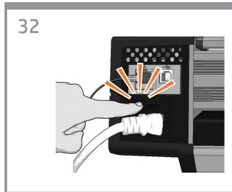
Ενεργοποιήστε το διακόπτη λειτουργίας που βρίσκεται στο πίσω μέρος του σαρωτή.
