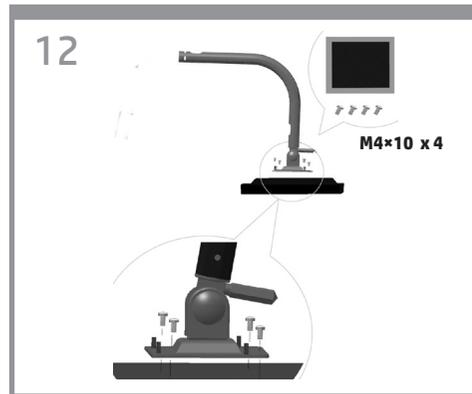
Χωρίς να αφαιρέσετε το προστατευτικό φελιζόλ, γυρίστε την οθόνη με ενσωματωμένο υπολογιστή ανάποδα και στερεώστε το βραχίονα στην πίσω πλευρά της με τέσσερις βίδες M4x4.
