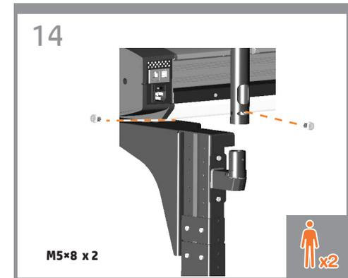
Τοποθετήστε το βραχίονα της οθόνης με ενσωματωμένο υπολογιστή στο βραχίονα στήριξης και στερεώστε τον με δύο βίδες.
