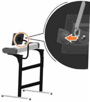
Εάν θέλετε η κλίση της οθόνης με ενσωματωμένο υπολογιστή να είναι σταθερή, αφαιρέστε το κεφάλι του παξιμαδιού και σφίξτε το παξιμάδι.
