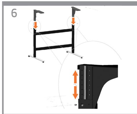
Τοποθετήστε τα στηρίγματα στις βάσεις και σταθεροποιήστε τα στο επιθυμητό ύψος με 2 βίδες σε κάθε βάση.
