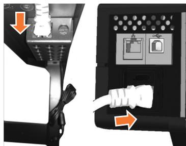
Συνδέστε το ένα άκρο του καλωδίου Y στο τροφοδοτικό (κάτω από το στήριγμα του σαρωτή, αριστερά ή δεξιά) και συνδέστε το άλλο άκρο στο σαρωτή.
