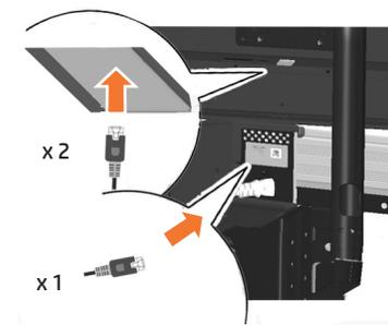
Συνδέστε τα καλώδια δικτύου στην θύνη με ενσωματωμένο υπολογιστή και συνδέστε το άλλο άκρο του καλωδίου δικτύου 3 m στην υποδοχή Ethernet που υπάρχει αριστερά στην πίσω πλευρά του σαρωτή. Συνδέστε το καλώδιο δικτύου 5 m σε μια υποδοχή δικτύου για να συνδέσετε την θύνη με ενσωματωμένο υπολογιστή στο δίκτυό σας.
