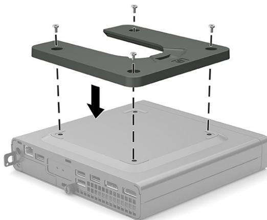
Para montar o computador em outro acessório de montagem, siga as instruções que acompanham o dispositivo de montagem para garantir que o monitor seja montado com segurança.
