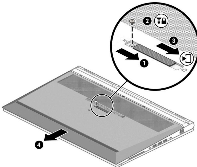
5. Betätigen Sie die Akku-Entriegelungsschieber **(1)**, um den Akku freizugeben.
