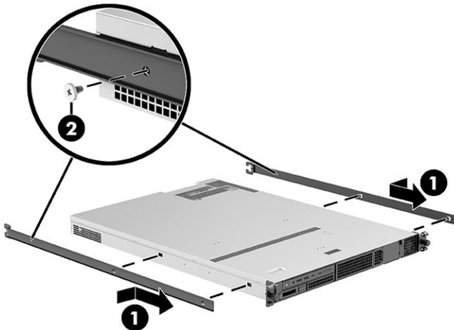
3. Faites glisser l'ordinateur dans le rack, en veillant à placer les glissières dans les rails.
