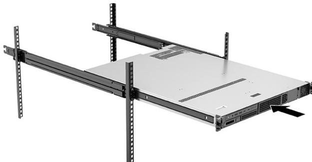
4. Fixez l'ordinateur dans le rack en faisant pivoter les vis de retrait du rack dans le sens des aiguilles d'une montre.
