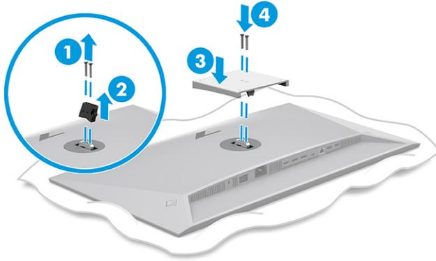
4. 모니터 헤드를 스윙 암 또는 기타 장착 장치에 부착하려면 장착 장치의 구멍을 통해 장착 나사 4개를 삽입하여 모니터 헤드 후면의 VESA 나사 구멍에 끼웁니다.
