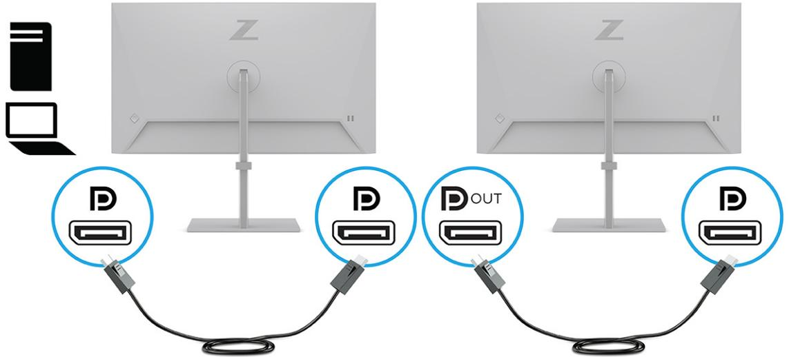
**참고:** 최대 4개의 추가 모니터를 연결할 수 있습니다. 체인의 최종 모니터를 제외하고 모두 DisplayPort 멀티 스트리밍을 지원해야 합니다. 예를 들어 4개의 모니터를 데이지 체인으로 연결할 경우 데이지 체인으로 연결된 4개의 모니터 중 3개에 DisplayPort 및 DisplayPort 출력 커넥터가 있어야 합니다. 체인의 마지막 모니터에는 DisplayPort 커넥터만 필요합니다.
