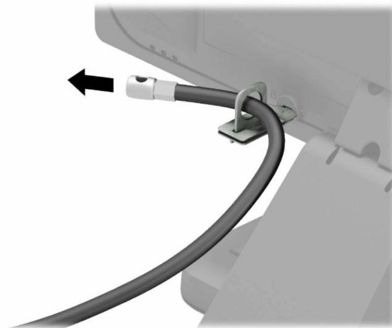
6. Připojte upevňovací prvek bezpečnostního kabelu k počítači pomocí vhodných šroubů pro vaše prostředí (1) a potom umístěte pomocné kabely do základny spojovacího prvku (2). Šroub není součástí dodávky.
