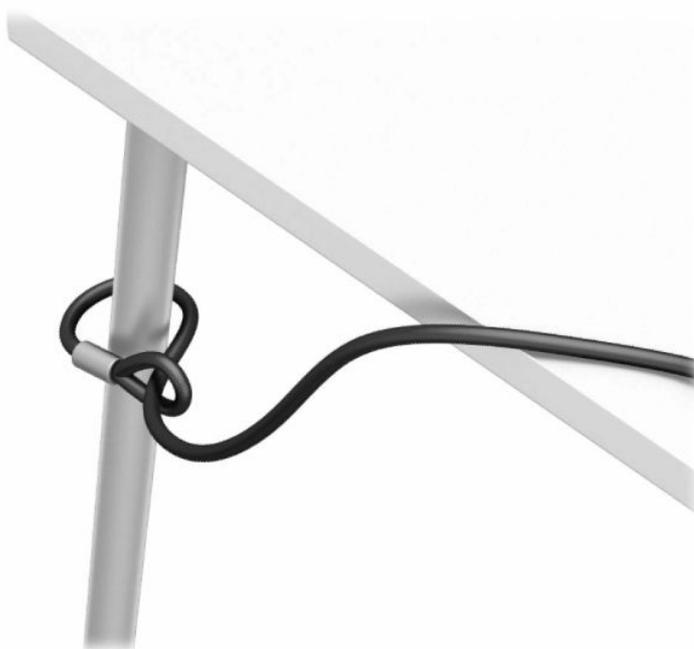
3. Protáhněte bezpečnostní kabel upevňovačem bezpečnostního kabelu.
