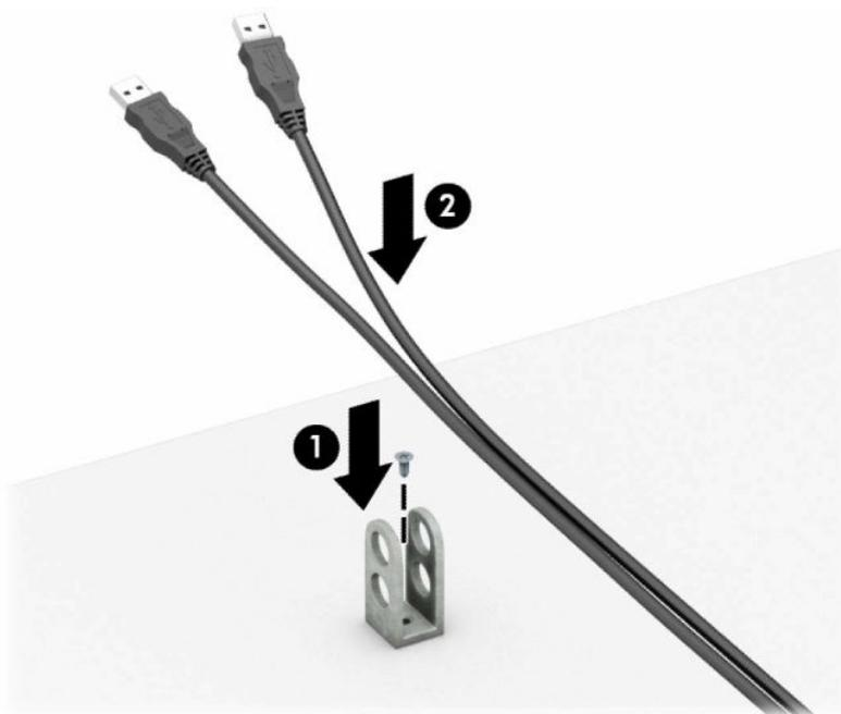
7. Protáhněte bezpečnostní kabel otvory v upevňovači kabelu příslušenství.
