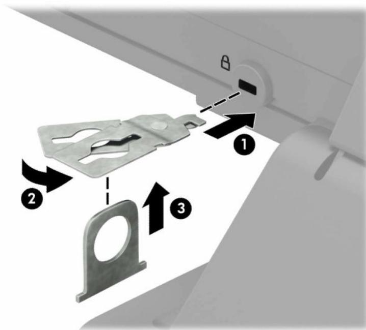
5. Protáhněte bezpečnostní kabel bezpečnostní úchytkou připevněnou k monitoru.
