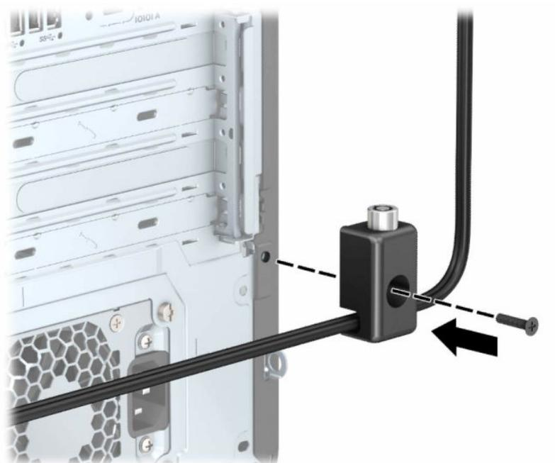
9. Konec bezpečnostního kabelu se zástrčkou zasuňte do zámku (1) a stisknutím tlačítka na (2) zámek aktivujte. Zámek lze otevřít pomocí dodaného klíče.
