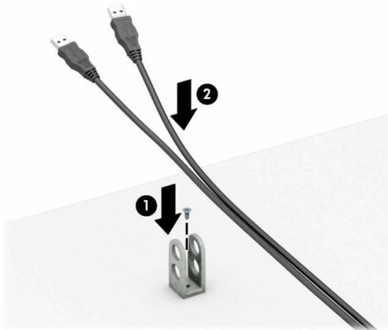
7. Potisnite varnostni kabel skozi odprtine v zapenjalu dodatnega kabla.
