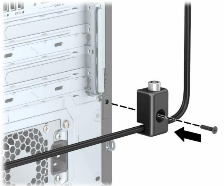
9. Vtič varnostnega kabla vtaknite v ključavnico (1), nato pa pritisnite gumb (2), da zaklenete ključavnico. Ključavnico odklenete s priloženim ključem.
