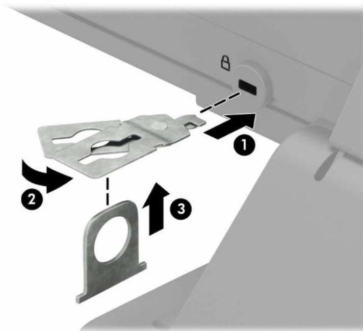
5. Potisnite varnostni kabel skozi varnostno vodilo, nameščeno na monitorju.
