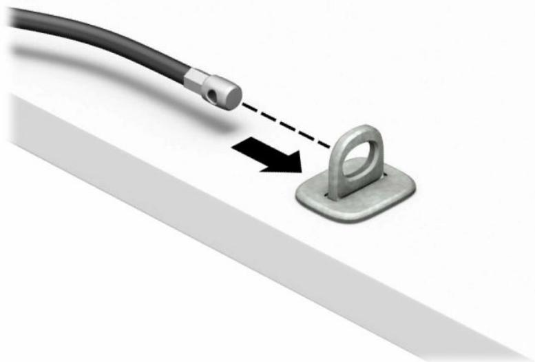
4. Розведіть у боки ручки замка монітора та вставте замок у гніздо безпеки на задній панелі монітора (1), зведіть ручки замка, щоб зафіксувати його на місці (2), а потім просуньте напрямну кабелю через замок монітора (3).
