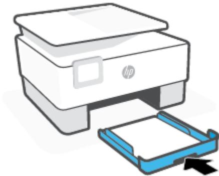
5. Vuelva a insertar la bandeja de salida en la impresora.
