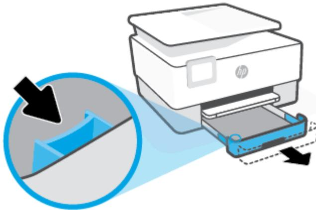
4. Cargue el papel en orientación vertical y con la cara que se va imprimir hacia abajo.
