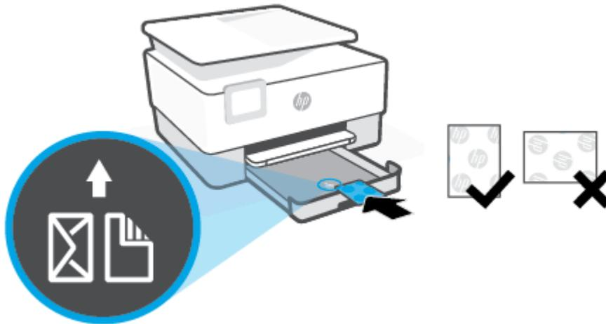
Asegúrese de que la pila de papel está alineada con las líneas de tamaño del papel apropiadas en la parte frontal de la bandeja. Además, compruebe que la pila de papel no supera la marca de altura de la pila en el borde izquierdo de la bandeja.
