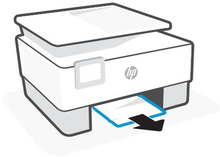
4. Vuelva a insertar la bandeja de entrada deslizando hasta que encaje en su sitio.
