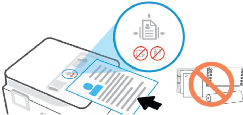
2. Deslice las guías de ancho de papel hacia dentro hasta que entren en contacto con los bordes izquierdo y derecho de la hoja.
