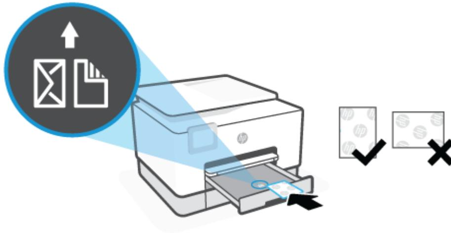
Asegúrese de que la pila de papel esté alineada con las líneas de tamaño del papel apropiadas en la parte frontal de la bandeja. Además, compruebe que la pila de papel no supera la marca de altura de la pila en el borde izquierdo de la bandeja.
