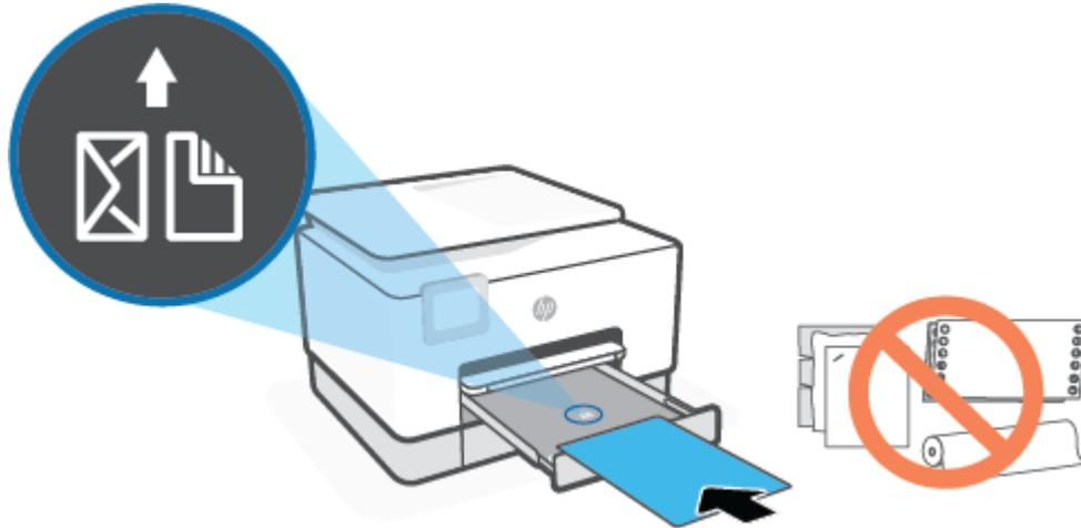
Asegúrese de que la pila de papel está alineada con las líneas de tamaño del papel apropiadas en la parte frontal de la bandeja. Además, compruebe que la pila de papel no supera la marca de altura de la pila en el borde izquierdo de la bandeja.
