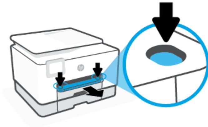
2. Retire completamente la bandeja 2 de la impresora.
