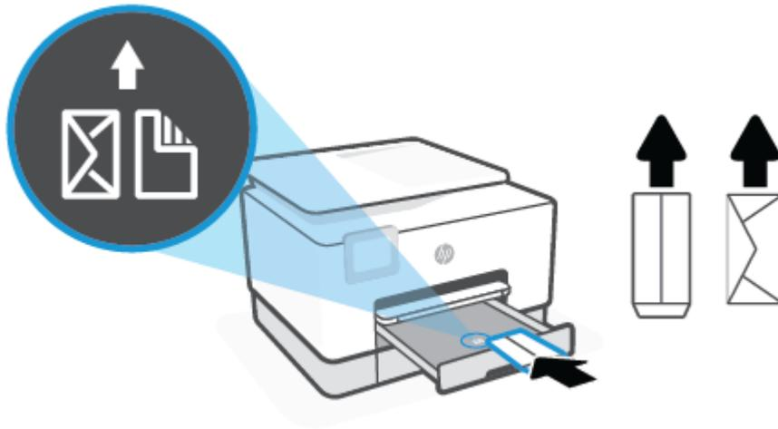
Asegúrese de que la pila de papel está alineada con las líneas de tamaño del papel apropiadas en la parte frontal de la bandeja. Además, compruebe que la pila de papel no supera la marca de altura de la pila en el borde izquierdo de la bandeja.
