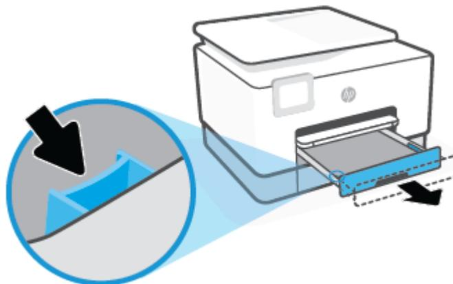
4. Cargue el papel en orientación vertical y con la cara que se va imprimir hacia abajo.
