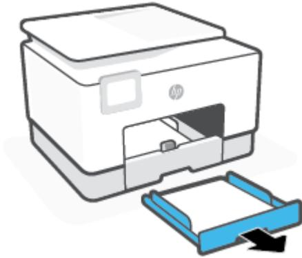
3. Compruebe el hueco en la impresora donde estaba la bandeja de salida. Extraiga el papel estacado del hueco.
