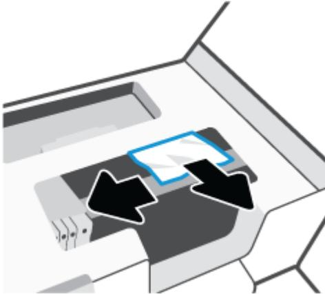
4. En caso necesario, desplace el carro totalmente al lado derecho de la impresora y extraiga el papel atascado o rasgado.
