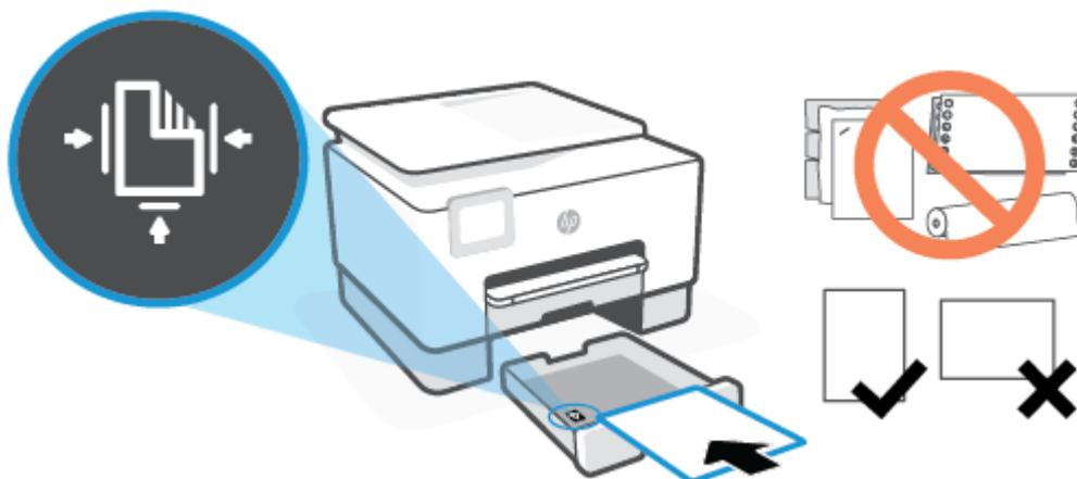
Asegúrese de que la pila de papel esté alineada con las líneas de tamaño del papel apropiadas en la parte frontal de la bandeja. Además, compruebe que la pila de papel no supera la marca de altura de la pila en el borde izquierdo de la bandeja.
