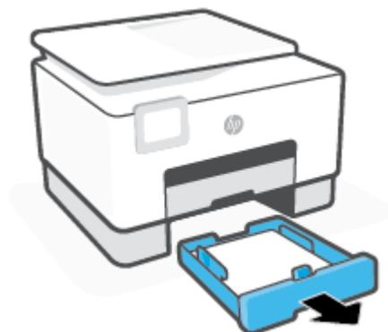
2. Compruebe el hueco en la impresora donde estaba la bandeja de salida. Extraiga el papel estacado del hueco.
