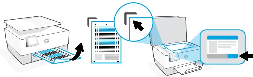
**NO** Bruk kontrollpanelet til å skrive ut og skanne nivelleringssiden.
