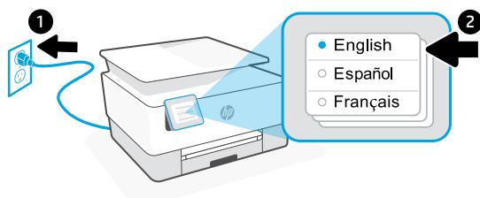
**NL** Steek de stekker in het stopcontact om de printer automatisch in te schakelen. Selecteer de taal en het land/de regio.
