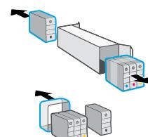
**NL** Open de voorklep en til vervolgens de toegangsklep voor de wagen bij de scannerklep omhoog. Pak de cartridges uit.
