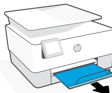
**FR** Ouvrez le bac à papier et sortez les guides. Chargez du papier de format Lettre ou A4 et ajustez les guides. Fermez le bac. Dépliez l'extension du bac de sortie.
