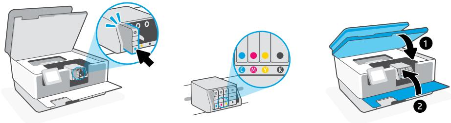
**NL** Plaats elke cartridge stevig in de aangegeven houder. Sluit beide kleppen.
