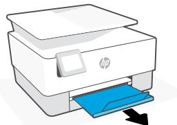
**LV** Atveriet papīra tekni un izbīdiet vadotnes. levietojiet vēstules vai A4 formāta papīru un pielāgojiet vadotnes. Aizveriet paplāti. Pavelciet atvērtā stāvoklī izvades teknes pagarinātāju.
