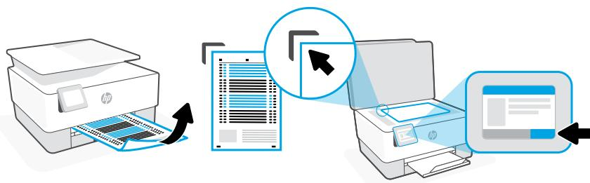
**LV** Izmantojiet vadības paneli, lai izdrukātu un skenētu izlīdzināšanas lapu.
