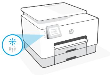
Wenn die blaue Wi-Fi-LED nicht blinkt, ist der Drucker möglicherweise nicht im Wi-Fi-Einrichtungsmodus. Starten Sie den Einrichtungsmodus neu:
