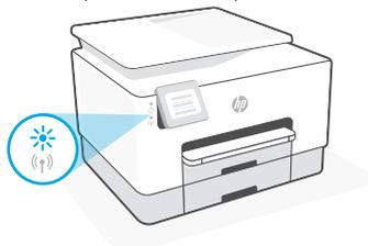
Dacă indicatorul luminos albastru Wi-Fi nu clipește, este posibil ca imprimanta să nu fie în modul de configurare a conexiunii Wi-Fi. Reporniți modul de configurare:
