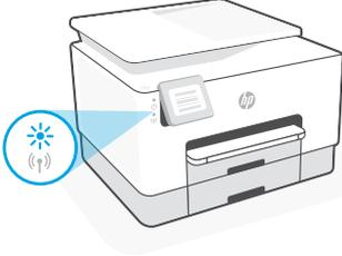
Αν η μπλε φωτεινή ένδειξη Wi-Fi δεν αναβοσβήνει, ο εκτυπωτής μπορεί να μην βρίσκεται σε λειτουργία ρύθμισης Wi-Fi. Επανεκκινήστε τη λειτουργία ρύθμισης:
