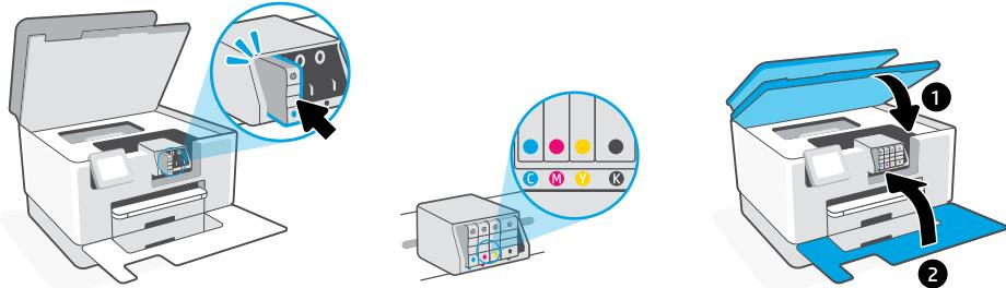
**NL** Plaats elke cartridge stevig in de aangegeven houder. Sluit beide kleppen.
