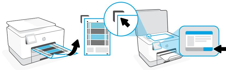
**NO** Bruk kontrollpanelet til å skrive ut og skanne nivelleringssiden.
