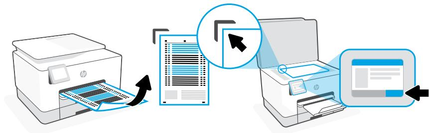
**NL** Gebruik het bedieningspaneel om de uitlijningspagina af te drukken en te scannen.
