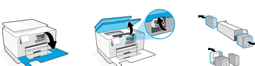
**NL** Open de voorklep en til vervolgens de toegangsklep voor de wagen bij de scannerklep omhoog. Pak de cartridges uit.
