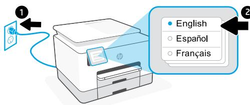
**NL** Steek de stekker in het stopcontact om de printer automatisch in te schakelen. Selecteer de taal en het land/de regio.
