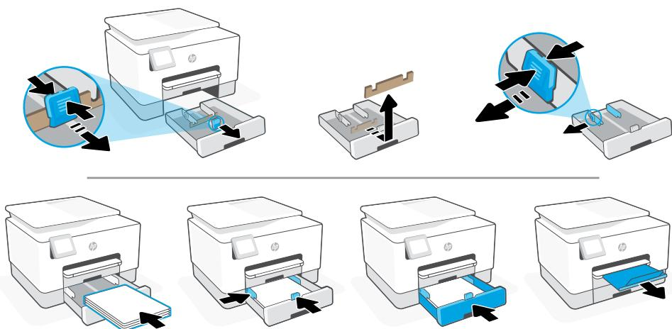
**FR** Ouvrez le bac à papier. Écartez le guide de longueur avant, retirez le carton et écartez les guides de largeur. Chargez du papier de format Lettre ou A4 et ajustez les guides. Fermez le bac et dépliez l'extension du bac de sortie.
