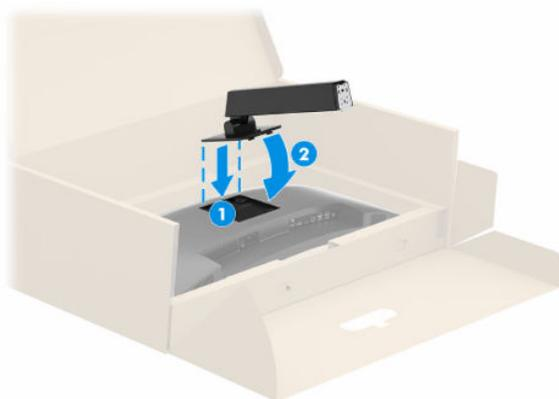
3. Con il monitor ancora rivolto verso il basso all'interno della confezione, inserire la base nella parte inferiore del supporto del monitor (1). Ruotare la base in senso antiorario. Ruotare la base in senso
