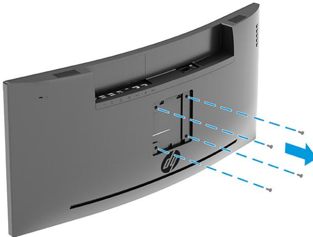
2. Per fissare la testa del monitor a un braccio snodabile o ad altri dispositivi di montaggio, inserire quattro viti di montaggio nei fori sul dispositivo di montaggio e nei fori per le viti VESA sul retro della testa del monitor.
