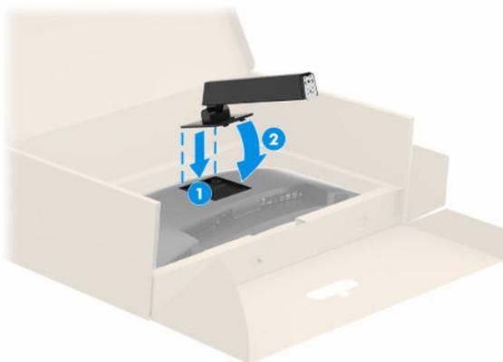
3. Con el monitor todavía colocado boca abajo dentro de la caja, inserte la base en la parte inferior del soporte del monitor (1). Gire la base en el sentido contrario a las agujas del reloj. Asegúrese de que las
