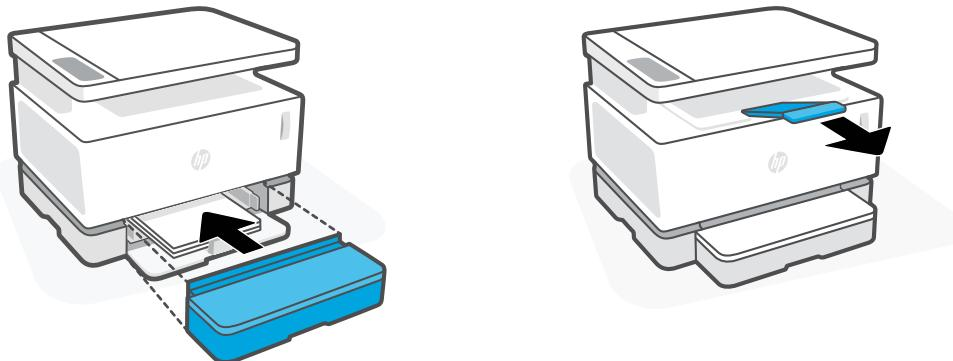
**FR** Installez le bac d'entrée, chargez le papier puis faites glisser le capot pour le placer au-dessus du bac. Déployez l'extension du bac de sortie.
