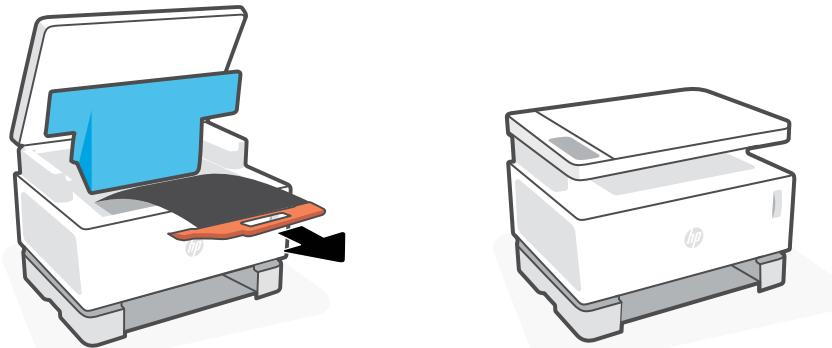
**FR** Retirez la bande protectrice de l'emballage. Soulevez le scanner et le capot supérieur. Retirez et jetez au recyclage la poignée plastique orange avec la feuille noire.
