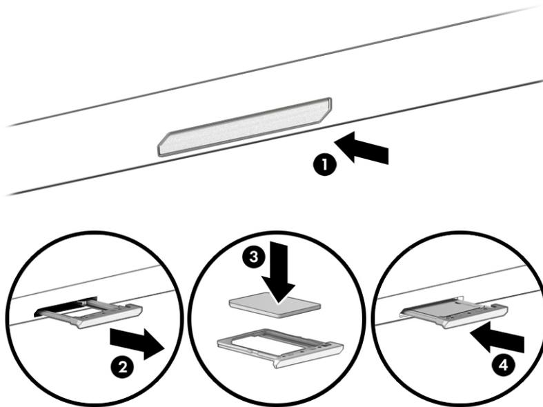
Drücken Sie vorsichtig auf das SIM-Karten-Zugriffsfach, um die SIM-Karte zu lösen, und das Fach tritt aus dem Steckplatz hervor. So können Sie die SIM-Karte entfernen. Entfernen Sie die SIM-Karte. Setzen Sie das Fach wieder in den Computer ein und drücken Sie vorsichtig auf das Fach, bis es fest sitzt.
