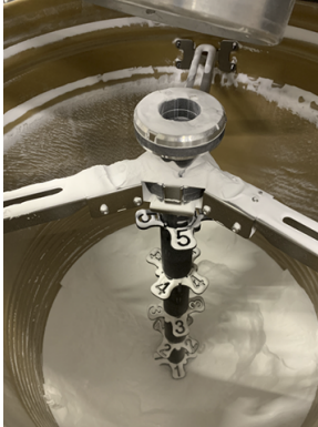
Abbildung 6-1 Die Ziffern im externen Behälter geben den Materialstand an.
