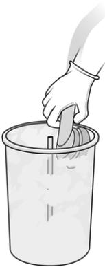
7. Inserte el nuevo filtro entre el recipiente y el tubo central, con el extremo cerrado en la parte superior y el extremo abierto en la parte inferior.
