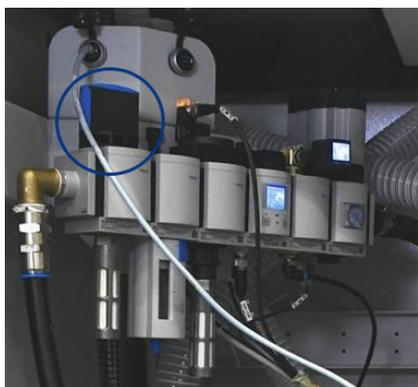
3. Retire el depósito de agua y la funda del filtro, y vacíe el depósito del separador de agua.
