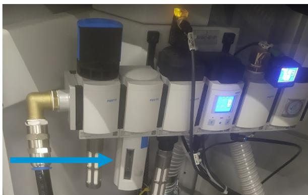
4. En todos los tubos de aire, compruebe si hay fugas, áreas dobladas u otros defectos que puedan impedir el paso del aire. Compruebe también que los conectores no tengan fugas. Puede inspeccionar visualmente los tubos y también escuchar si se escapa el aire mientras la estación de recogida está en funcionamiento.
