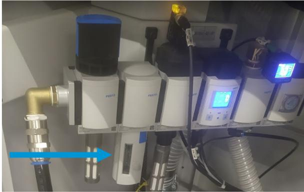
5. Desatornille la cubierta del filtro en la parte inferior del filtro y sustituya el filtro.
