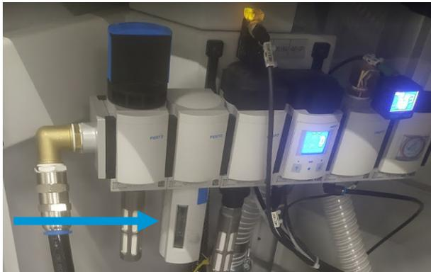
5. 鬆開過濾器底部的過濾器蓋，並更換過濾器。
