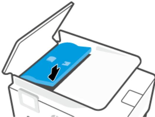
6. Schließen Sie die Abdeckung des Vorlageneinzugs, bis sie einrastet.
