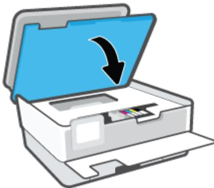
9. Schließen Sie die Frontklappe.
