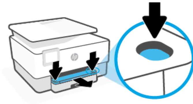
2. Entfernen Sie das Zufuhrfach, indem Sie es vollständig aus dem Drucker herausziehen.
