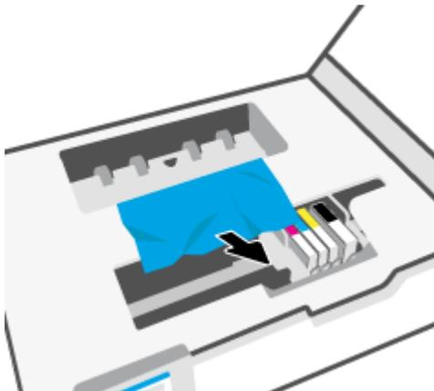
7. Setzen Sie die Papierpfadabdeckung wieder in den Drucker ein, bis diese einrastet.
