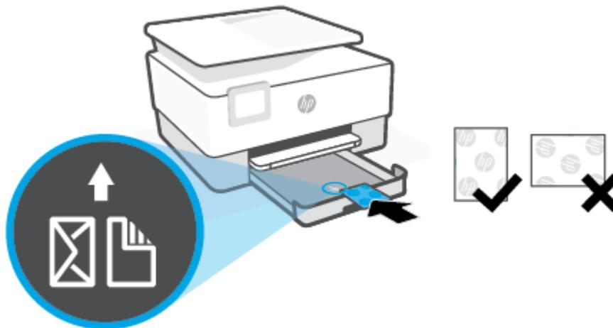
Vergewissern Sie sich, dass der Karten- oder Fotostapel an den entsprechenden Papierformatlinien an der Vorderseite des Faches ausgerichtet ist. Stellen Sie darüber hinaus sicher, dass der Karten- oder Fotostapel die Markierung für die Maximalhöhe des Stapels an der linken Kante des Faches nicht überschreitet.
