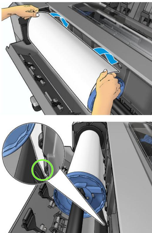
6. Coloque el papel en la impresora hasta que note resistencia y que el papel se dobla suavemente. Cuando la impresora detecta el papel, lo carga automáticamente.
