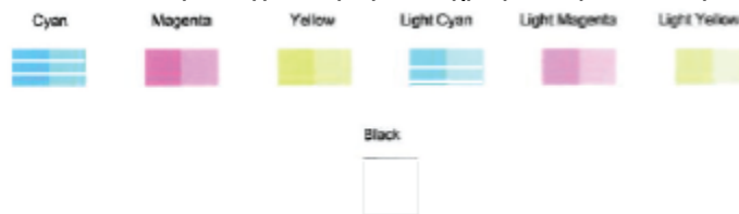
Εικόνα 9-2 Παράδειγμα τετραγώνου χρώματος με ελαττώματα
