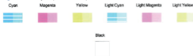
Figura 9-2 Ejemplo de bloques de color con defectos
