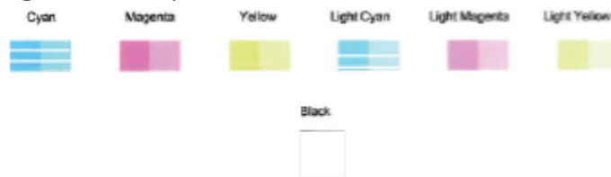
Figura 9-2 Esempi di blocchi di colore con difetti
