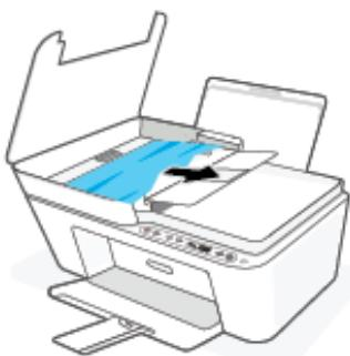
**FORSIGTIG:** Hvis papiret rives i stykker, når du prøver at fjerne det fra rullerne, skal du kontrollere, om der sidder iturevet papir fast i rullerne og hjulene, som kan blive inde i printeren.
