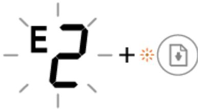
Der Drucker empfängt einen aus mehreren Seiten bestehenden Druckauftrag. Er erkennt, dass die Papierlänge für den zu druckenden Auftrag nicht der Länge des im Zufuhrfach eingelegten Papiers entspricht. Daraufhin wird die erste Seite des Druckauftrags mit Fehlern gedruckt.
