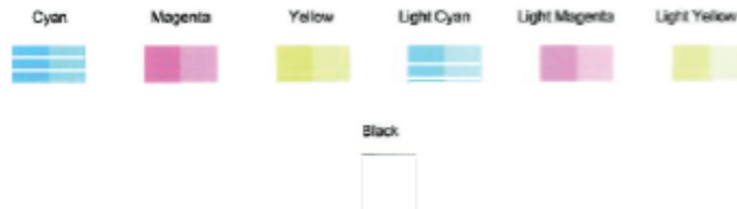
Figura 9-2 Exemple de blocuri de culoare cu defecte
