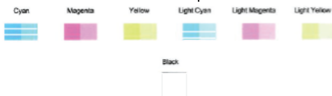
Slika 9-2 Primer barvnih blokov z napakami
