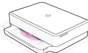
**PT** Conecte o cabo de força para ligar automaticamente. Aguarde até a iluminação da impressora ficar roxa e continue na etapa 3.
