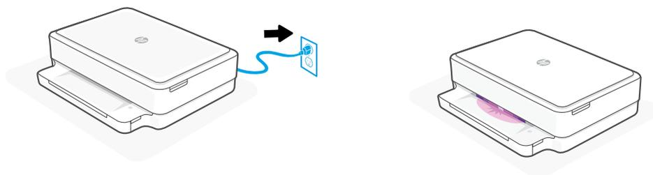
**SL** Priključite tiskalnik na električno omrežje, da ga samodejno vklopite. Počakajte, da začne osvetlitev tiskalnika svetiti vijolično, nato pa nadaljujte z 3. korakom.
