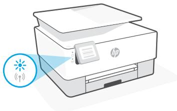
Wenn die blaue Wi-Fi-LED nicht blinkt, ist der Drucker möglicherweise nicht im Wi-Fi-Einrichtungsmodus. Starten Sie den Einrichtungsmodus neu:
