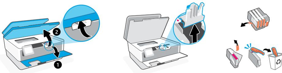
**NL** Open de voorklep en til de toegangsklep voor cartridges bij de scannerklep omhoog. Verwijder de plastic beveiliging. Verwijder de cartridgeverpakking, de tape en de oranje beveiligingen.
