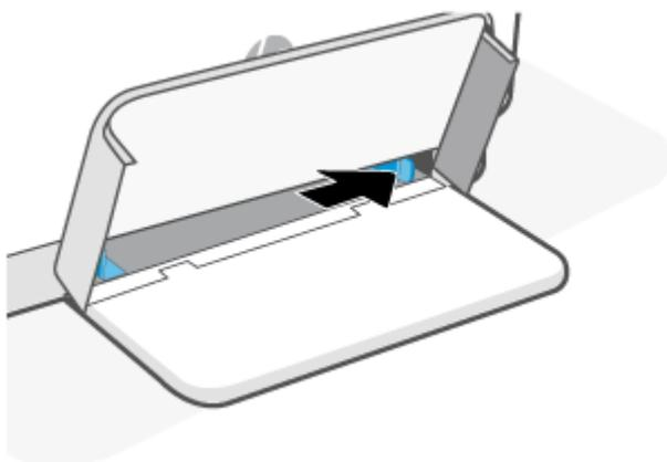
3. Legen Sie den Papierstapel mit der Oberseite nach vorne und der zu bedruckenden Seite nach oben in das Zufuhrfach ein.
