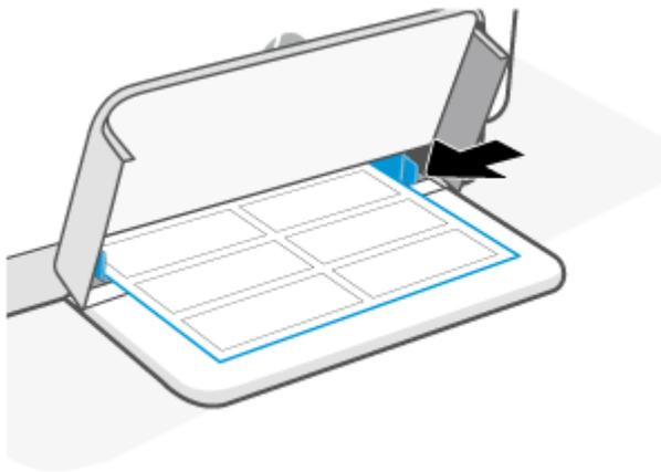
3. Schieben Sie die Papierführungen bündig an die Kanten der Druckmedien heran.
