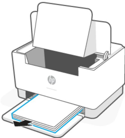
3. Fassen Sie die gestauten Druckmedien mit beiden Händen an dem am besten zu sehenden Bereich (einschließlich der Mitte) und ziehen Sie sie vorsichtig aus dem Drucker heraus.
