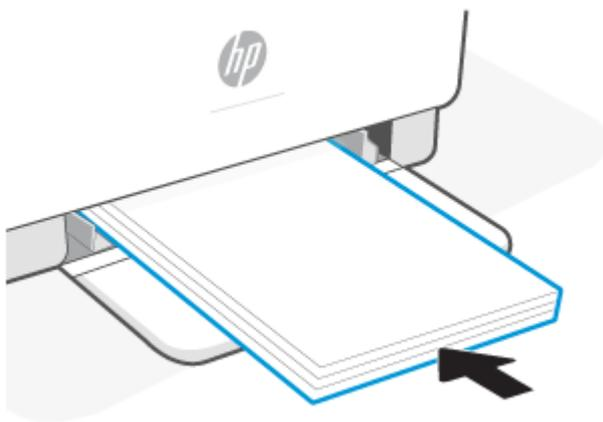
4. Schieben Sie die Papierführungen bündig an die Kanten der Druckmedien heran.
