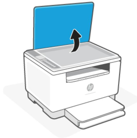
2. 请将原纸张打印面朝下放入，并将其与玻璃板左后角上的标记对齐。
