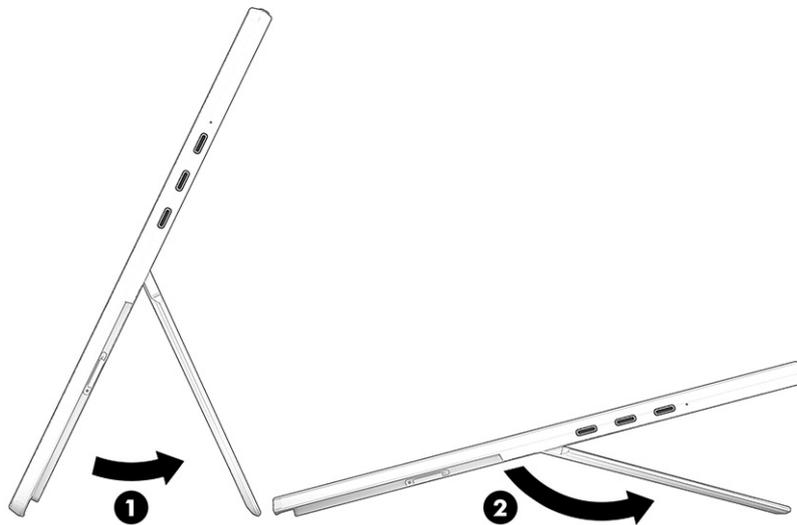
3. Um den Ständer zu schließen, schieben Sie den Ständer zum Computer hin, bis er bündig an der Unterseite anliegt.
