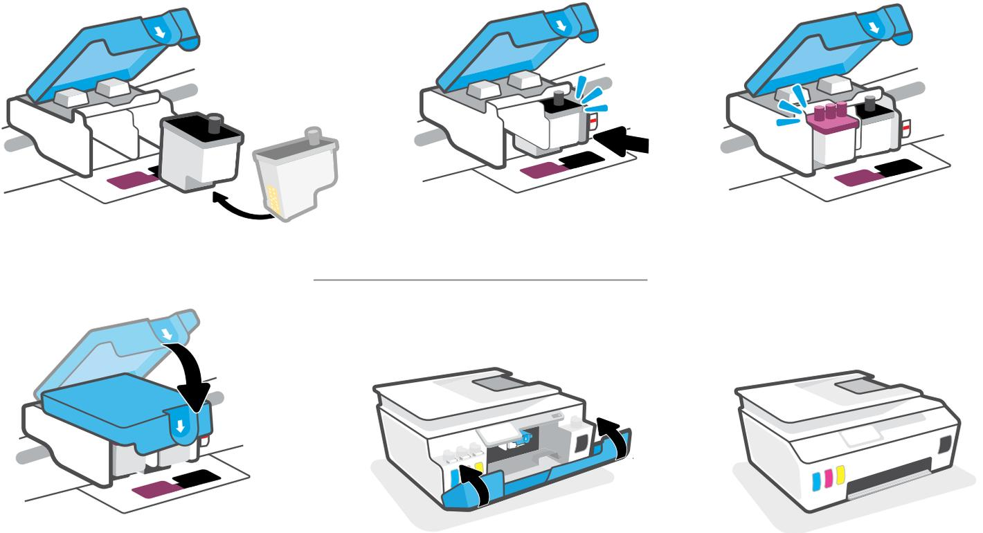
**RU** Установите печатающие головки. Закройте синий фиксатор и дверцы.
