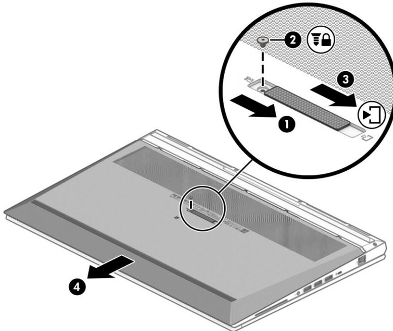
5. Deslice los pestillos de liberación de la batería (1) para liberar la batería.
