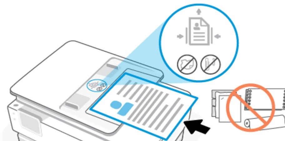
2. 将纸张宽度导轨向里滑动，直到与纸张的左右两侧接触。
