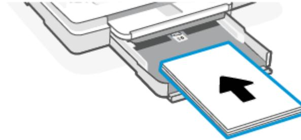
5. Faites glisser les guides de largeur jusqu'à ce qu'ils entrent en contact avec le bord de la pile de papier.
