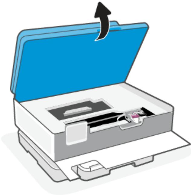
3. Si le chariot d'impression n'est pas obstrué, déplacez-le délicatement le plus loin possible sur la gauche de l'imprimante et retirez le papier coincé. Si nécessaire, répétez l'opération en déplaçant délicatement le chariot d'impression vers la droite de l'imprimante.
