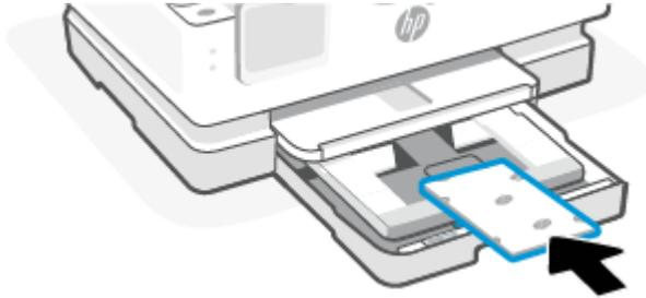
Vérifiez que la pile de cartes ou de papier photo est alignée sur les lignes de taille de papier appropriées à l'avant du bac.
