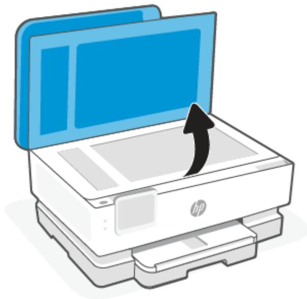
2. Limpe o vidro e a parte posterior da tampa do scanner utilizando um pano macio e sem fiapos levemente umedecido com um produto neutro de limpeza de vidros.
